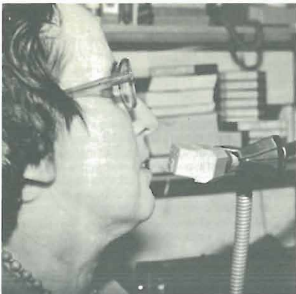
Fig. 2 - Uno dei più interessanti sensori è il Linguaduc NJ 1-111 che si basa sulle proprietà fluidiche dell'aria.
